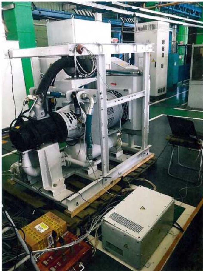
Испытания ИП-40 (БПС-60-02 с ИД-40К) в качестве привода винтового компрессора АКВ 6/1 Л У2 разработанного для тягового подвижного состава
